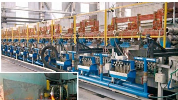
*Автоматическая кузнечная линия горячей штамповки производства ОАО «Тяжспецмаш»*
