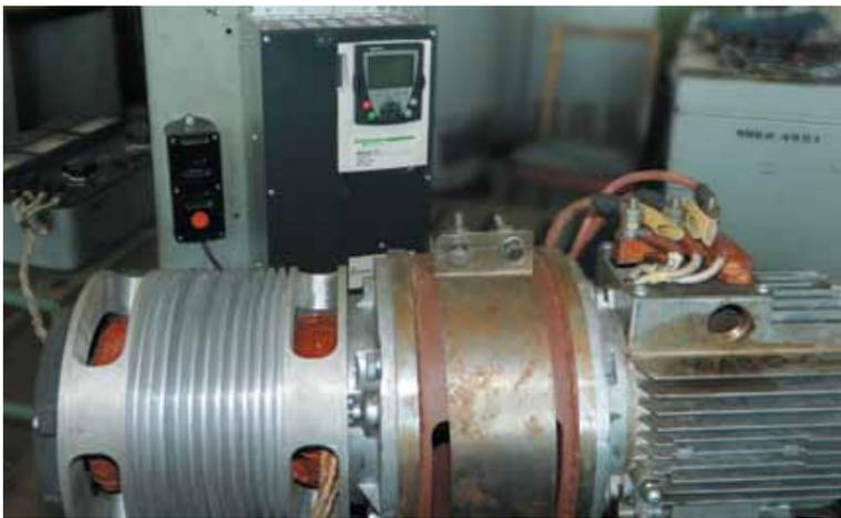
Опытный образец высокооборотного двигателя для ВКС на испытательном стенде СКБ
