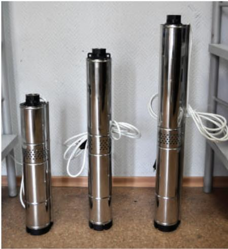
конденсатор уменьшает падение напряжения в кабеле питания. От проникновения воды двигатель насоса защищает по корпусу двойной каскад резиновых уплотнительных колец, по линии вала — двойной каскад из керамо-графитового торцового уплотнения и армированной резиновой манжеты от ведущих европейских производителей.
